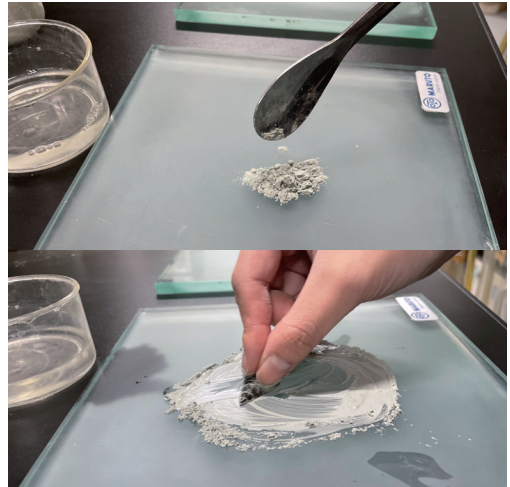
Fig. 8. #1500 と #4000 の研磨粉とガラス板を用いて鏡面研磨処理の様子.
