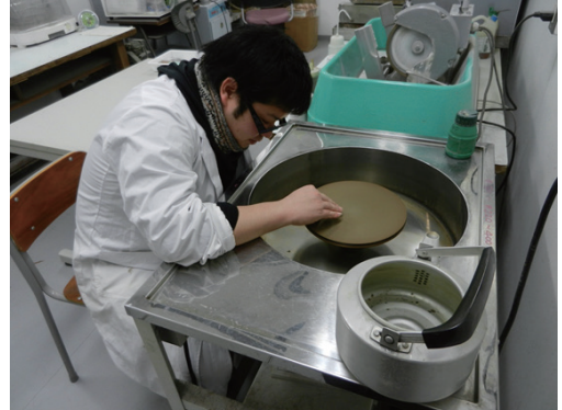
Fig. 4. 研磨処理. 荒削りの様子. グラインダーに研磨粉(カーボランダム)をのせ、水をまき、研磨している様子.
